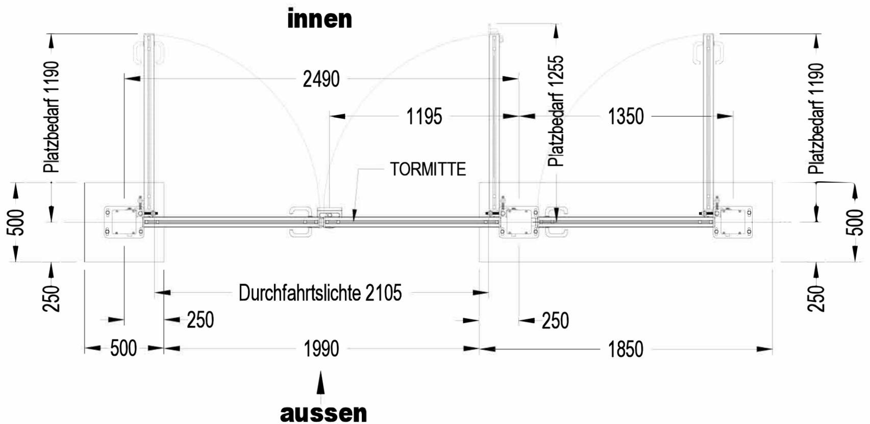
Auf dem Fundamentplan sind konstruktive Mindestgrößen angegeben, die Auslegung und Baugrundbeurteilung obliegt dem Errichter. Bewehrungen (Beispiel: Korb aus Matte R188, Betonüberdeckung 30mm) und Fundamentgröße sind den örtlichen Bodenverhältnissen anzupassen. Betongüte mindestens C25/30 frostsicher. Bitte beachten Sie die vorgeschriebenen Sicherheitsabstände.
